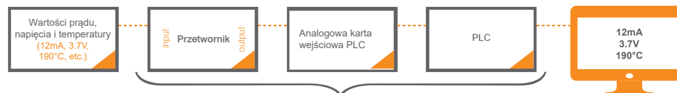
ASCON 352 - przetwornik sygnałów. Odczyt bezpośredni
